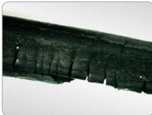
极端热强度对O型密封圈的影响
