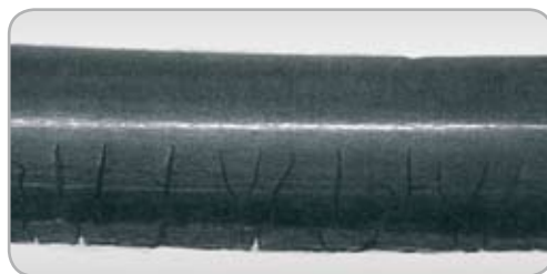
化学腐蚀对O型圈的影响
